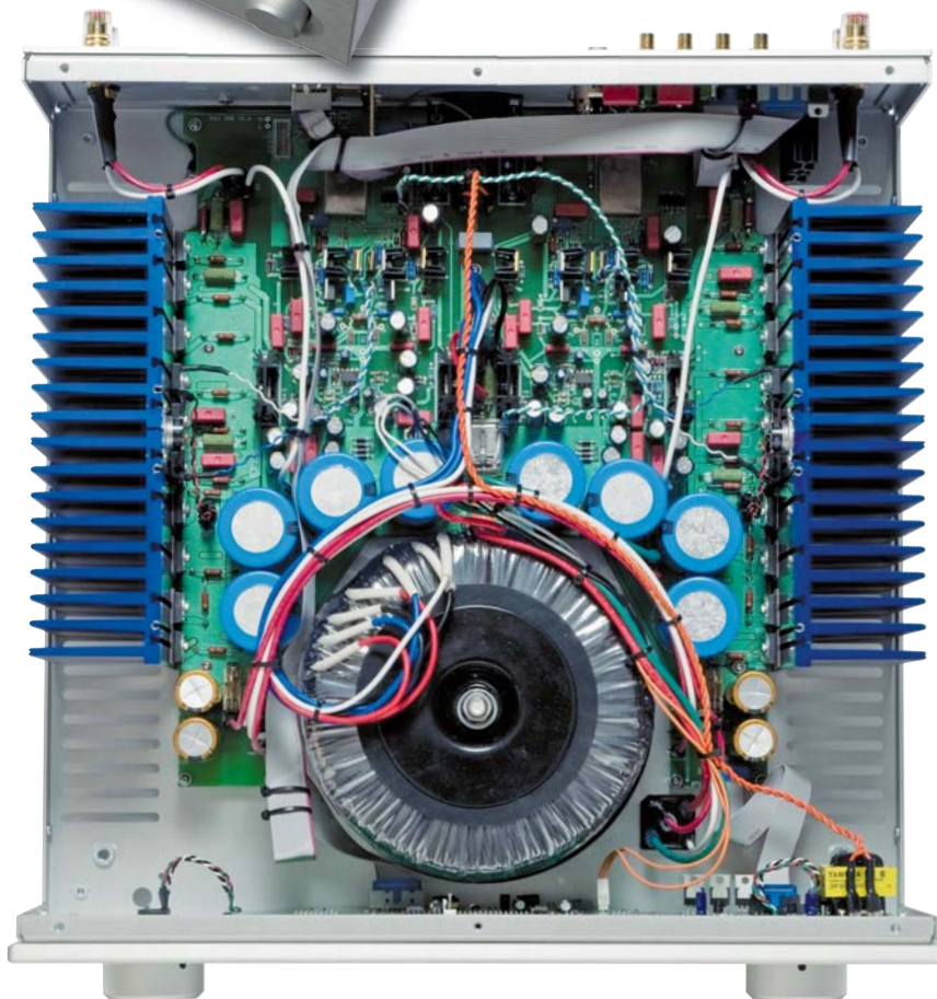
Le transformateur torique très puissant et les nombreux condensateurs de filtrage sont à l'origine des excellentes performances sur transitoires du KWI 200.
