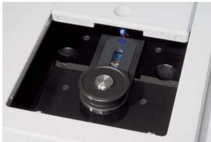
*Le chargement se fait par une trappe placée sur le dessus, avec palet presseur*
