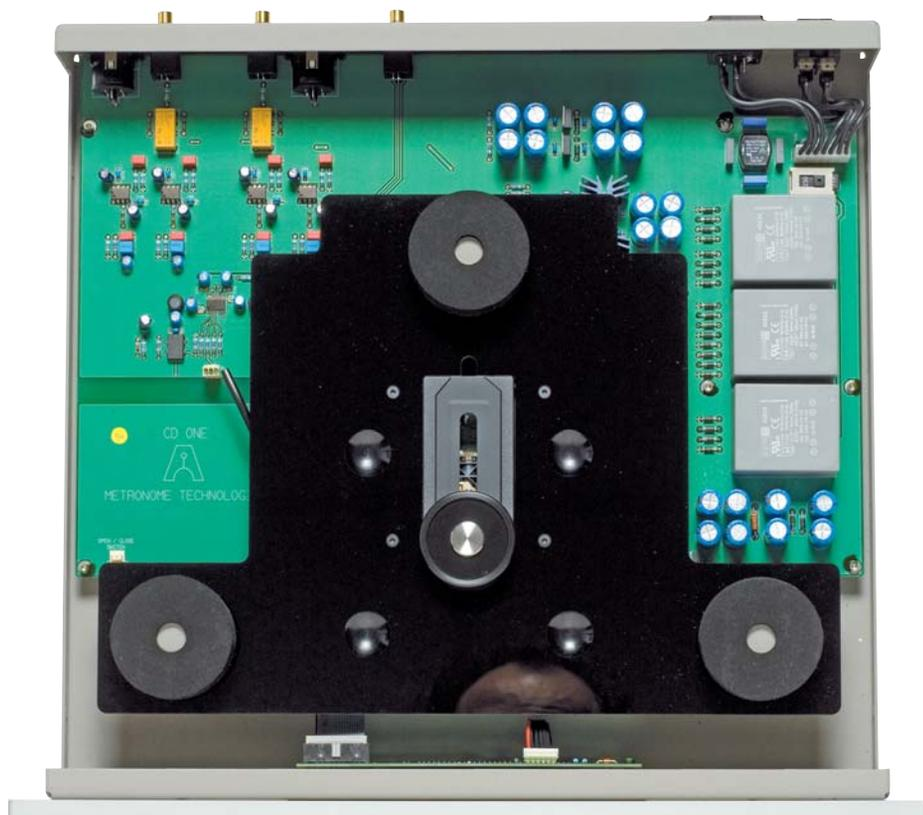
*L'implantation interne est exemplaire de netteté et de maîtrise du câblage. Notez la véritable platine décollée, sur trois points, pour la mécanique Philips, et les trois doubles transformateurs d'alimentation, à droite*
