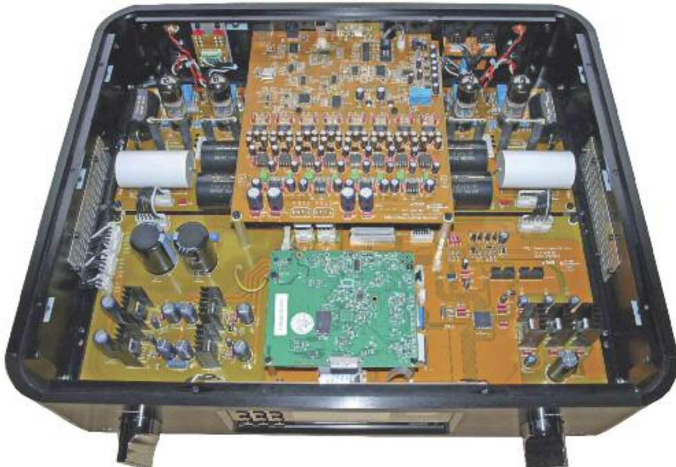
En vert, la carte lecteur réseau ; sur le dessus, les DACs ; en arrière et sur les côtés, les quatre doubles triodes à chauffage indirect 6H30EB et les capacités Mundorf Mcap Silver/Gold/Oil.
