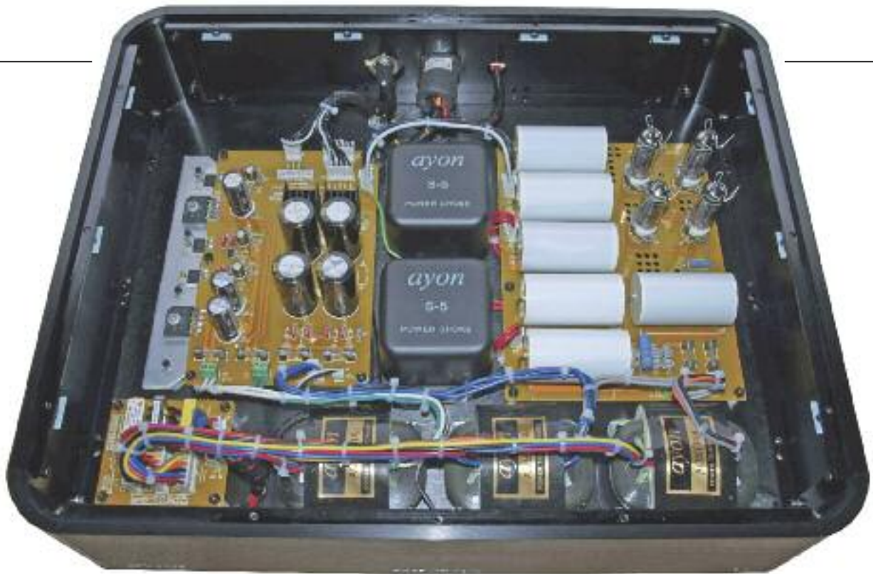
L'alimentation séparée avec ses trois transformateurs R-Core, ses selfs Power Choke, ses capacités de grade audiophile et ses tubes de redressement.
