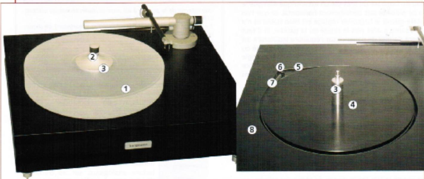
Vue de face de la platine avec plateau et vue de la platine sans plateau pour découvrir le contre-plateau et son axe de centrage 1 - Plateau en méthacrylate de 30 cm de diamètre et 5 cm d'épaisseur, d'un poids de 4 kg avec évidement central de 10 cm pour compenser l'épaisseur de l'étiquette du disque. 2 - Palet-presser vissant. 3 - Axe en acier de 2 cm de diamètre de cen-
