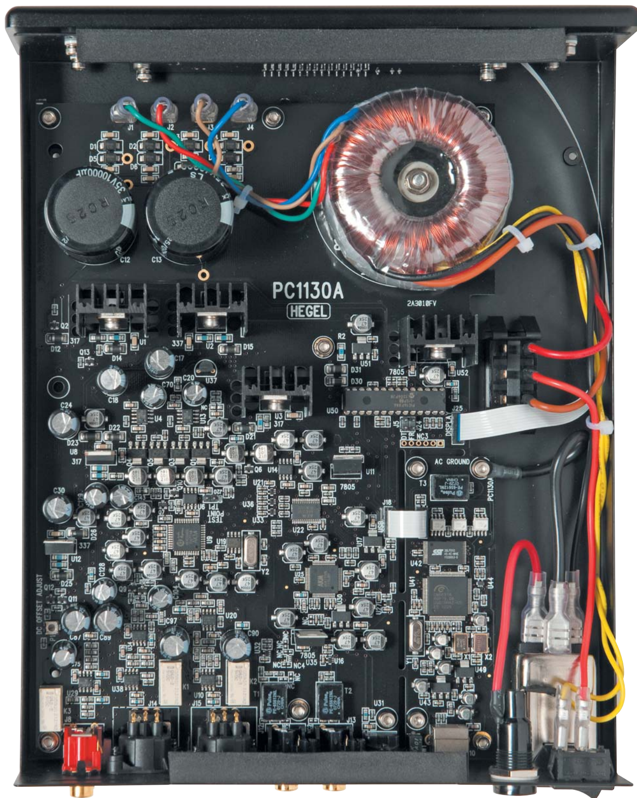
La carte mère, ses dix régulateurs (dont quatre sur dissipateurs), ses trois Asahi Kasei (U22, U25 et U9), et ses excellents étages de sortie, en bas à gauche.
