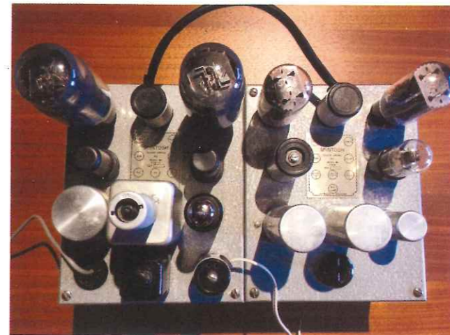
Vue aérienne du bloc mono 50W-1 (pour 50 W et 1 canal).
